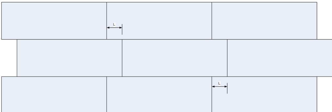
Εικόνα 2. Διάταξη εφαρμογής μεμβρανών. Η διάσταση L κυμαίνεται μεταξύ 25-35 φορές το πάχος της μεμβράνης.
